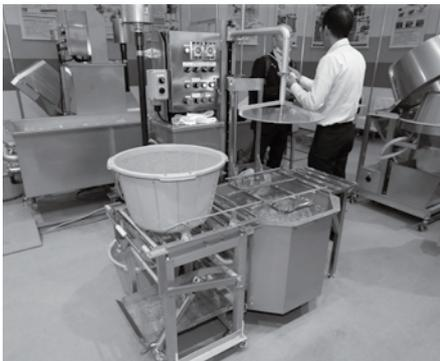
1976年の創業当初から食品洗浄機の製造を手がけている小嶺機械（本社長崎市）。なかでも異物除去洗浄機と野菜洗浄機は各業界から高い評価を受け、漬物、カット野菜、惣菜、海産物、食肉業界の問題解決と省力化に貢献している。今回の出展の目玉は、連結によって洗浄・殺菌・冷却・すすぎが自動で行える「ざるカゴ式野菜洗滌機（KWM-888MC-A型）」。最新型自動投入仕様で今回が初出展だ。そのほか、連続式・コンベア付バッチ式・小型バッチ式の異物除去洗浄機、ネギ・原体用洗浄機、ざるカゴ専用容器洗浄機などの実演もあり、来場者の目を引きつけていた。「当社は機械による洗浄テストも随時受け付けております。虫などの異物混入クレームで困っている、殺菌で思っていたような結果が出ない、生産拡大・新洗浄ラインを検討中など、食品の洗浄や異物除去、殺菌に関することはなんでもお問い合わせください」（担当者）。
