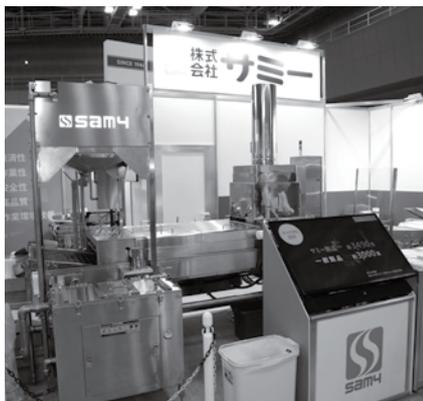
兵庫県小野市のサミーは、フライヤーひと筋の老舗メーカー。今回は学校給食・コンビニ用フライヤーを展示し、社長自ら試食用の揚げたてコロケを来場者にふるまっていた。フライヤーの投入部には、隣接するブースで協働ロボットを展示する㈱アールティ社製の自動投入装置を装備。フライヤー本体は、ムラなくカラッとジューシーに揚がる遠赤外線ヒーターの採用が特徴だ。また、フライヤーの上部カバーに特殊フィルターを付けた油煙回収装置もオプションで取り付け可能。フードをなくしてダクト内火災や熱気を防ぎ、作業環境を改善する独自開発の装置で交換作業も容易だという。さらに油タンクは劣化を防ぐ冷却機能付きで、冷却パイプを通して温まったお湯は洗浄時にも使用可能。底にたまった揚げカスは回収装置を取り外して簡単に掃除でき、油槽内のキャタピラコンベアにはマイクロディンプル処理を施してあるため衣も剥がれにくい。使う側の意見を徹底的に取り入れたフライヤーだ。
