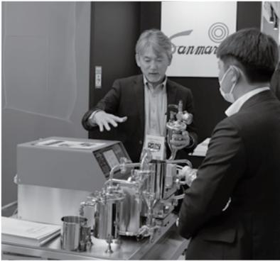
静岡県三島市に本社を構える三丸機械工業は、高圧式ホモジナイザーの専門メーカー。ホモジナイザーとは、液体中の粒子を均一に加工することにより製品の品質を向上させるための機械で、液体（たとえば乳製品・飲料・調味液など）に高圧力をかけホモバルブを通過させて、液体中の粒子を小さく均一化するしくみだ。今回の出展ブースの見どころは、高精度なデータ収集を可能とするラボ用ホモジナイザー「エコナイザーシリーズ (LABO-01・02)」。もともと食品用に開発された同機だが、ブースには化粧品関係の来場者も多く見られた。「このシリーズは、効果的な乳化分散を可能にした卓上型のコンパクトなラボ用ホモジナイザーです。ボタンひとつで全自動サンプリングが行えて操作は簡単。少量でもサンプルを作成でき、ライン機とラボ機のデータ整合性が取りやすいので、研究者の悩みを解決してくれるはずです」と担当者は胸を張った。
