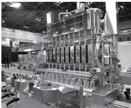
コンベアの上を流れるビンの音が心地よく響く新宅工業。金沢を拠点とするボトリングシステムメーカーの同社は、FOOMA JAPAN出展が今回で10回目。充填ラインの上流から下流まで、すべてをフルオーダーメイドで手がけ、長年使用するための整備もきっちり行う頼りになる企業だ。「FOOMA JAPANは、既存のお客さまと直接お会いできる貴重な機会」と語ってくれたのは、営業部の東谷さん。ブースに再現された充填ラインで、とくに注目はライン式充填機ウェイトフィラLFJだ。手洗い洗浄部分が少なく、ノズルとボトルが非接触なので衛生的。圧力制御付き加圧タンク採用でさまざまな液種に対応する。そして、容器の風袋引き後に設定した重量で充填するため、液体の歩留まりを高めるといふ。ロータリ式と比べ型替え時間を短く、機械価格も安価であるため引き合いが増えているとのことだ。
