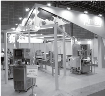
神戸の菓子製造機械メーカー、アマギのFOOMA JAPAN出展は6年ぶり2回目。今回、コーポレートカラーのオレンジをきかせたブースには、テンパリングマシンなどチョコレート関連の機器を9種類そろえた。イチオシはブースに9mの長さで置かれたクーリングトンネル。ベルト幅300～1200mm、長さは工場に合わせて2m単位で接続延長が可能だ。冷却方法は、直接冷却（ダイレクトクーリング）、間接方法（インダイレクトクーリング）、混合冷却の3種類で、ワンタッチで切り替えができる。軽量なものを冷却する場合、直接冷却では吹き飛ばしてしまわないよう風向きを研究し、ジェット気流で製品を下方向に抑え込みながらできるだけ早く冷やす新開発のシステムを取り入れた。また、冷風の完全循環システム、送風ファンの節電制御などで省エネルギーも実現。今回の出展で、冷凍食品のクーリングに使えないかとの問い合わせもあったという。
