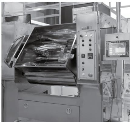
製菓・製パンを中心とした業務用の食品機械を製造・販売しているフジイ機械製作所。商品開発からアフターサービスまでを一貫して手がけ、特に攪拌機・成型機分野で食品メーカーの省力化・省エネルギー化に貢献している。今回の展示の目玉は、クッキーやビスケット、サブレなどの高粘度の生地に対応した横型ミキサー「ワーナーミキサー(1・2・3・8袋用)」。「2本のブレード羽根によってムラなく生地を練り上げ、メカニカルシールの採用により通常のパッキンよりも生地漏れが少ない」(担当者)の「同機の特徴だ」という。そのほかにも、手練りと同じように攪拌・煮炊きできる「回転式万能練機」、ミキサーへ直接粉をふるいながら搬送する「サンタリーシフター」などの機械を揃え、来場者の関心を集めていた。「私たちが目指しているのは、お客さまに『おいしい』と笑顔で言っただけの商品づくりのお手伝いなんです」。高性能の製品に興味を持った来場者の訪問も多く、連日賑わいを見せていた。
