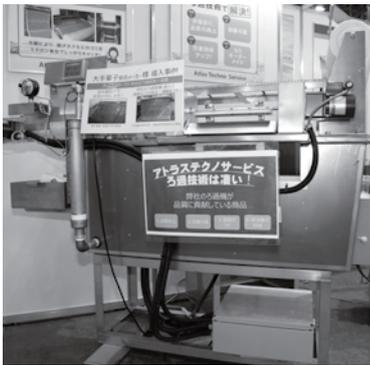
神戸に本社を置く、ろ過装置・真空フライヤー専門メーカーのアトラステクノサービス。同社の「全自動連続循環濾過装置」はインスタントラーメン業界において、国内シェア50%。油などの被処理液がろ紙を通過し連続的にろ過し、出てきた $\mu$ 単位のゴミ・カスをすぐに取り除き、常にきれいな油で生産できる仕組みが特徴だという。ろ紙の目詰まりを検知してロール状にセットした自動巻取り機構により、ろ紙交換作業の無人化、清掃も容易で画期的な製品だ。もうひとつの看板製品は「真空フライヤー」で、高真空下で100℃以下の食用油を熱媒体として食材をフライ（乾燥）する装置。これにろ過技術を活用して常にきれいな油で食材（農産・海産物など）を色味・風味・栄養価を損なうことなく高い脱油率でサクサク食感の食材の製造が可能になるという。この技術を活用して、地元の規格外の農産物を使用したスナック菓子を製造販売する関連会社も設立。社長自ら多角的にSDGsに取り組む企業姿勢と「当社の装置自体が営業マンです」と胸を張ってアピールしていた。
