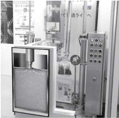
自動車や船舶などに使われる「すべり軸受」を開発・製造する大同メタル工業（東京都品川区）。ポンプ製品でも定評がある同社がFOOMA JAPANに出展したのは、非接触型ロータリーポンプの応用製品「ドラムフィーダー」。ショートニングや練りわさび、つばあんなど、ひっくり返したドラム缶から落ちないほど高粘度の食品でも缶の底まで楽々吸い上げ、製造ラインへ定量的に自動で直接送り出すことができるため、作業効率が格段にアップする。組み込まれたロータリーポンプは非接触型のため摩耗粉が出ず、完全なサニタリー性を実現。さらに搬送液を漏らさないメカニカルシールは自社製造で、ランニングコストを大幅に削減できる。ローターも多種類から選ぶことができるので「具の噛み応えを残したい」などの細かなニーズにも対応できると来場者から好評を得ていた。
